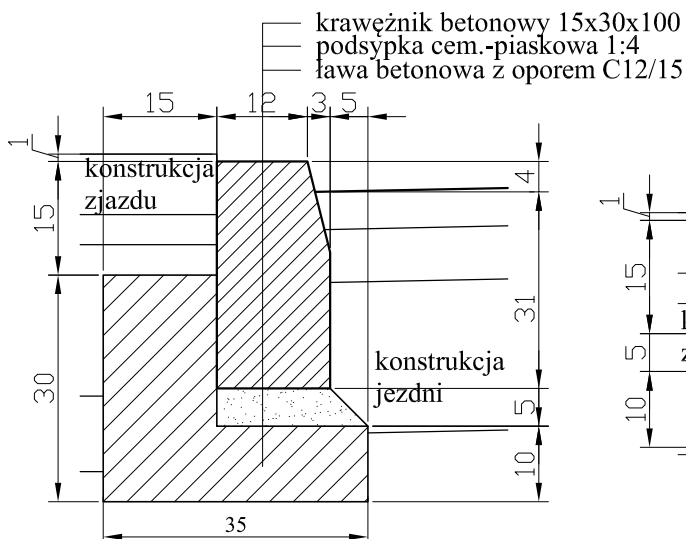
Szczegół nr 1 krawężnik zaniżony skala 1:10
